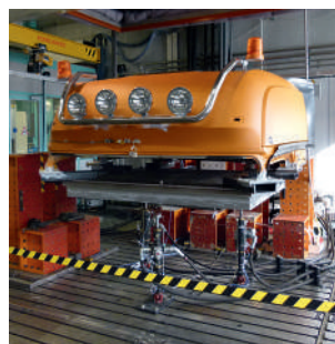
Гидроимпульсный испытательный стенд имитирует выбоины и плохие дорожные условия.
