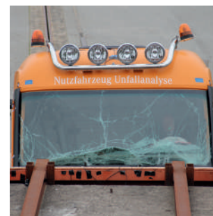
Изгиб и излом: держатель фары переднего света, монтируемый на крышу, в имитации аварии.
