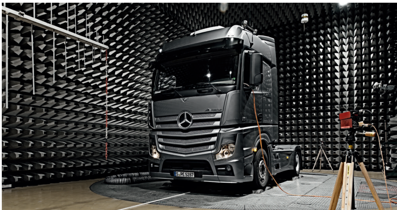
Испытания на ЭМС в зале, специально защищенном от внешних электромагнитных помех.
