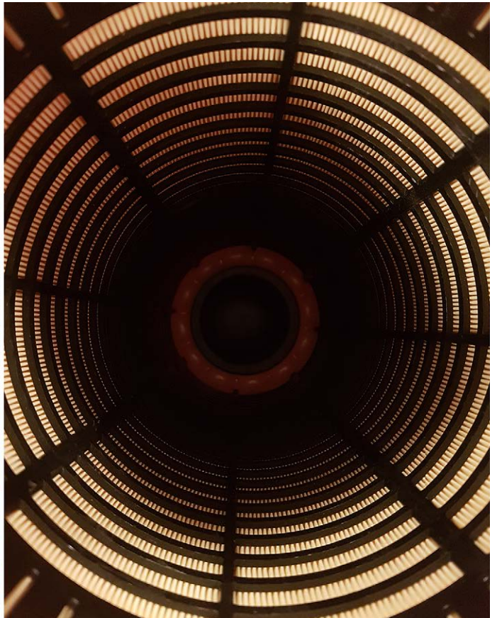
Альтернативный фильтр легко просвечивает, в то время как оригинальный фильтр практически не просвечивает
