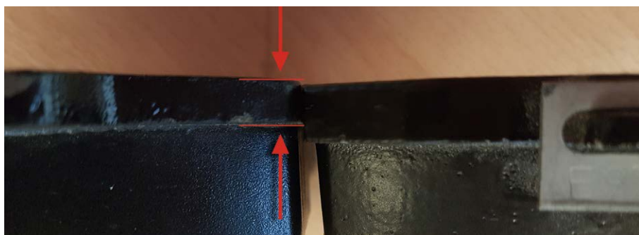
Металлическая основа у оригинальной колодки толще
