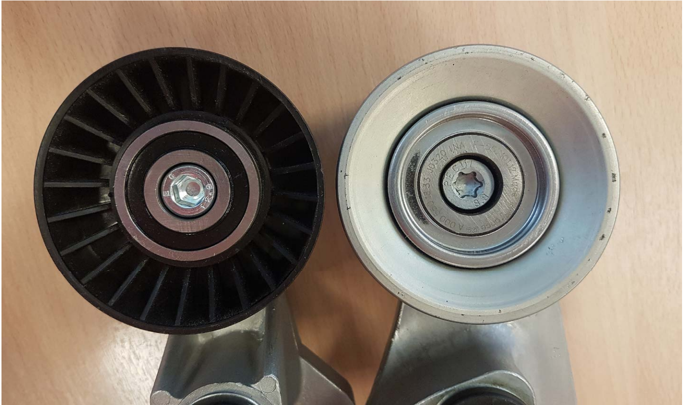
Альтернативный ролик пластиковый, с ребрами жесткости
