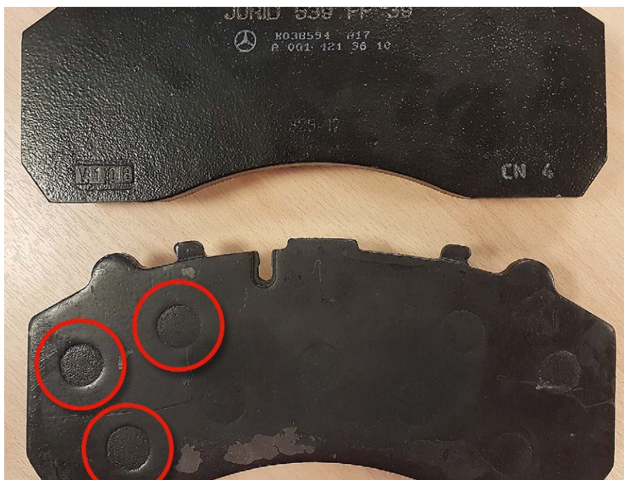
На альтернативной колодке видны отверстия в основании
