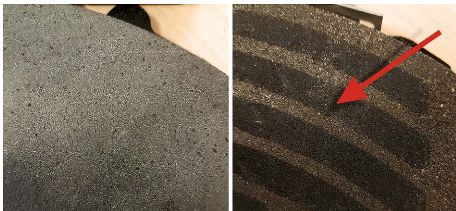
Нанесенные на оригинальную колодку полосы защищают колодку от масла и грязи в момент ее установки на СТО
